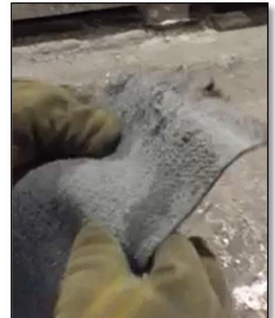
TXP600 Silicone noir après avoir été immergé quelques secondes dans une cuve d'aluminium en fusion.
